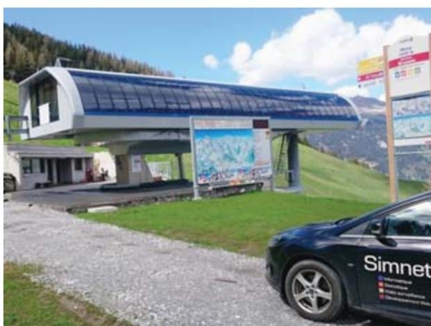
La récupération des calories des armoires de puissance de la remontée mécanique de Châble-Bruson par une pompe à chaleur permet de chauffer à moindre coût les 100 m<sup>2</sup> du bâtiment attenant. LDD
